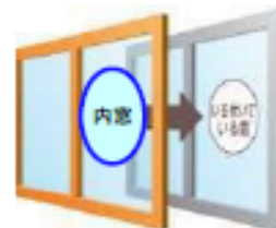
窓の断熱改修工事
